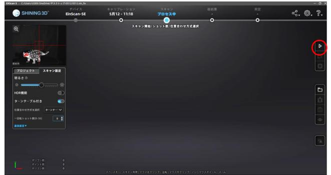
2. 一回転分スキャンが完了すると、そのスキャンデータが表示されます。この状態では最新スキャンを表示、編集が出来ます。画面右下の✓を押すと編集確定し、×を押すとスキャンデータが削除されます。
