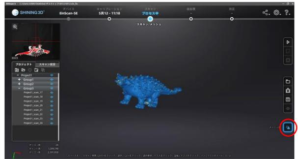
2. メッシュ化の方法を選択します。「穴埋め」は点群データを取得できなかった部分も強制的に穴埋めするので、3Dプリントを行う際にはこちらを選択します。スキャンが十分に行えていない場合は意図しない形状になる場合もあります。
