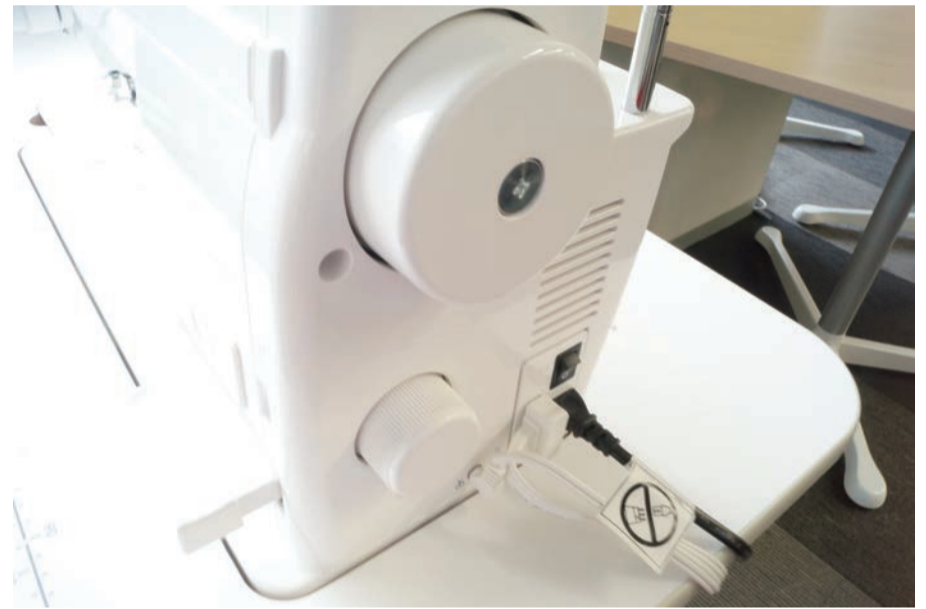
はずみ車(上)、縫い目粗さ調節ダイヤル
