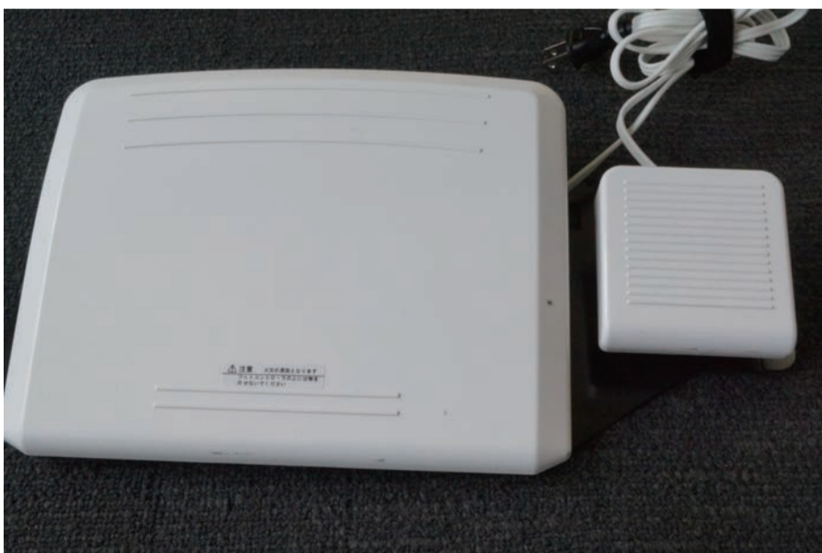
フットコントローラー(左), 糸切りスイッチ(右)
